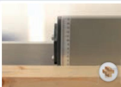
*Skala am Anschlag zum Messen der Werkstückdicke
