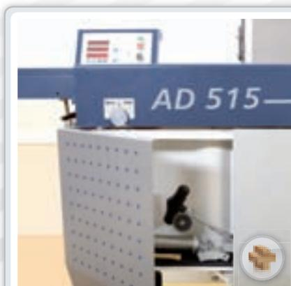
*Praktisches Werkzeugfach in Maschinenfront integriert*
